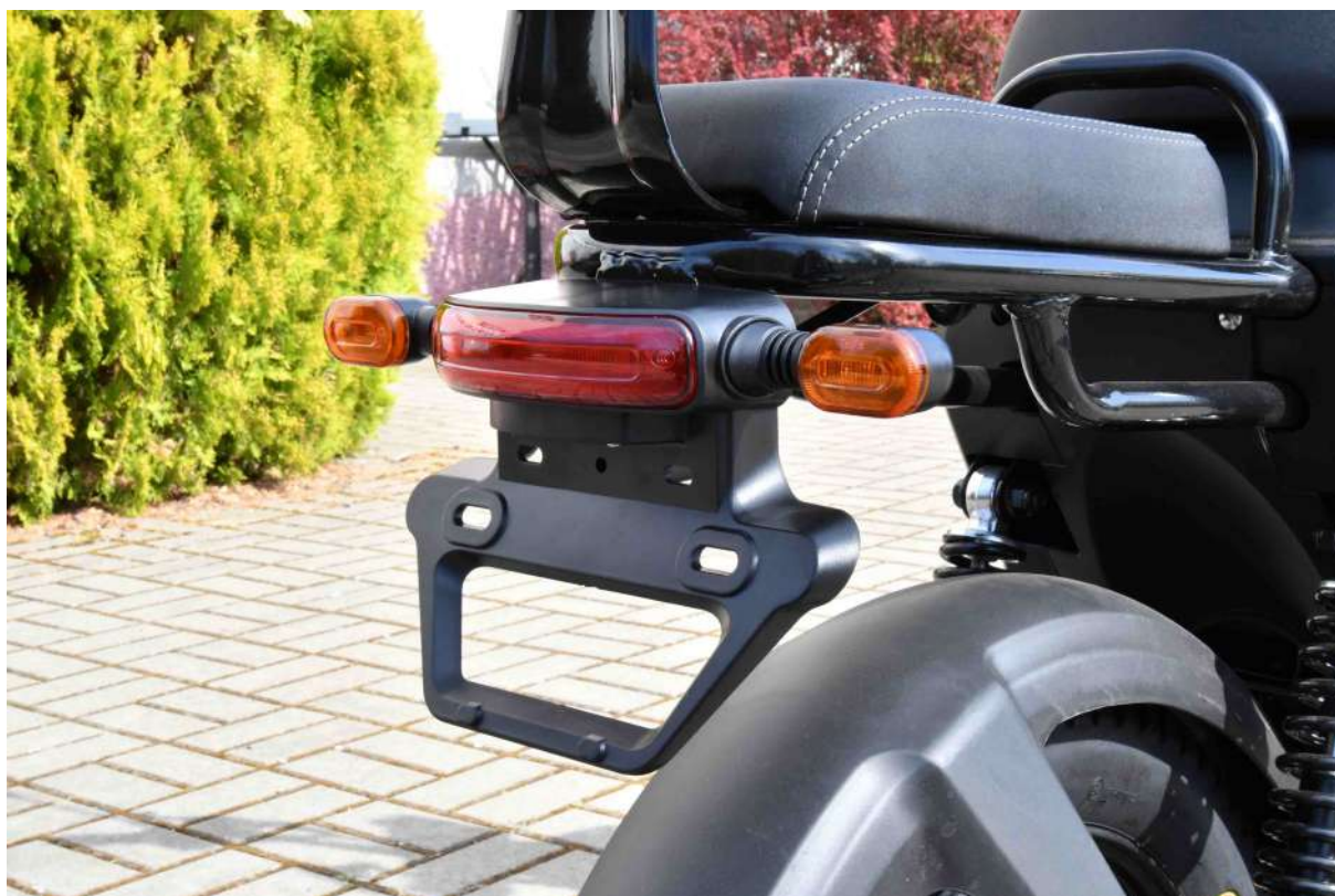
11. Namontujemo sedlačku a zacvaknemo plast
