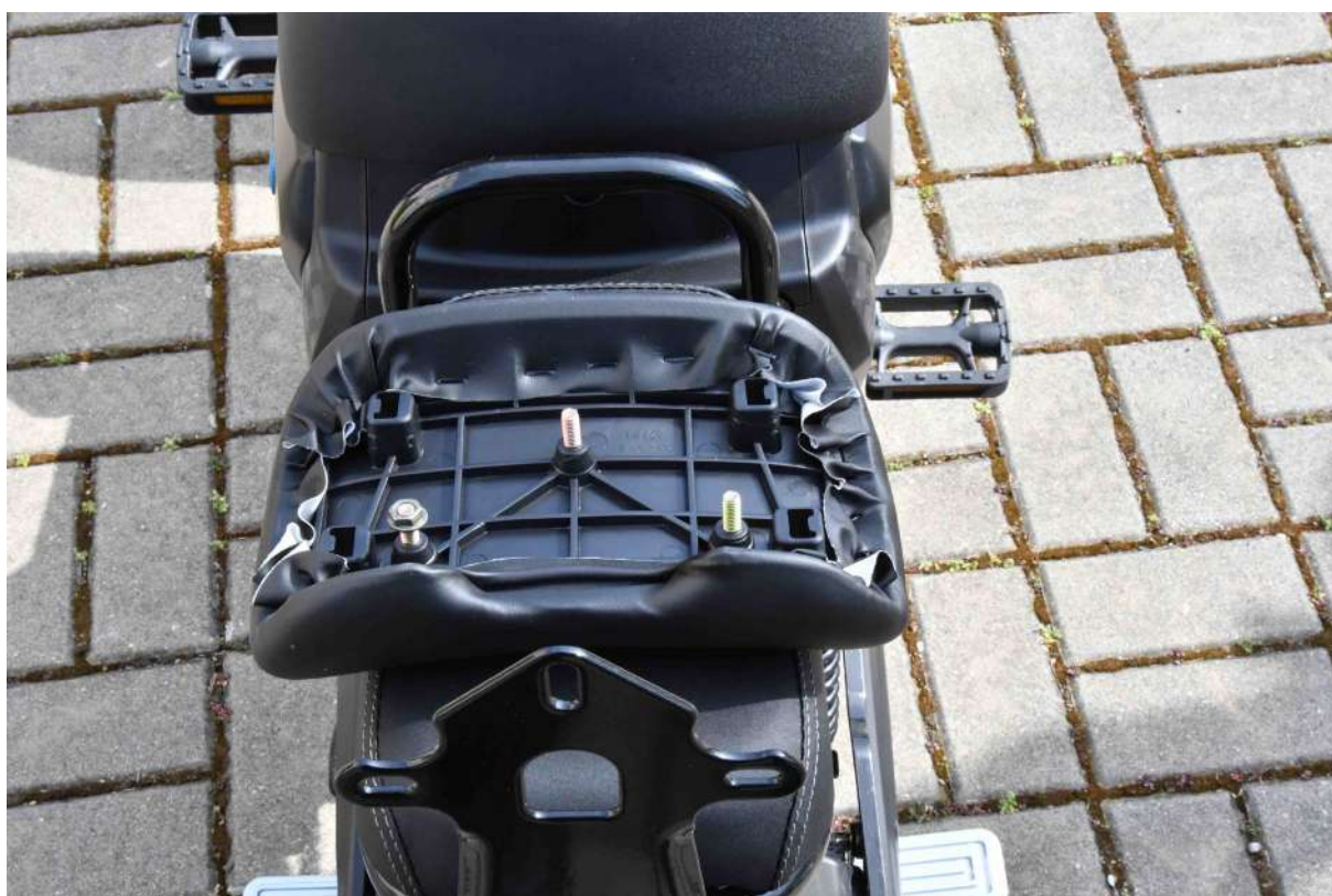
11. Namontujemo sedlačku a zacvaknemo plast
